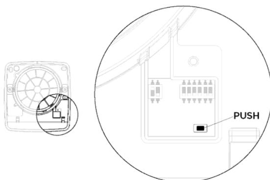
Una volta effettuato il reset l'unità emetterà un segnale acustico. A questo punto è necessario spegnere l'unità tramite l'interruttore principale e riaccenderla.
