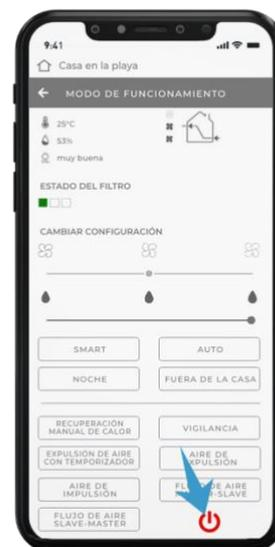
Para acceder a este modo, es necesario ingresar en «Modo de funcionamiento» y presionar APAGADO.
